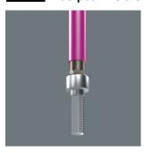
La retenue de la vis à six pans sur la clé mâle coudée est assuré par une bille. Particulièrement utile dans les espaces de travail difficile d'accès, où l'on ne peut pas se servir de l'autre main pour maintenir la vis.
