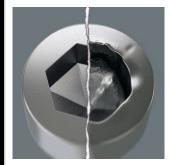
Le problème des vis à six pans creux tient à la finesse des surfaces d'appui sur lesquelles s'opère la transmission de la force depuis l'outil. Résultat : la tête de vis peut être endommagée. Les outils Hex-Plus possèdent des surfaces d'appui plus larges qui empêchent ce problème. Le couple transmis
