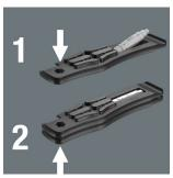
L'embout 4-en-1 se clipse dans le démonte-pneu 9504. Le démonte-pneu 9505 peut s'empiler par-dessus de sorte que les démonte-pneus et l'embout forment un ensemble compact.
