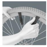
Les démonte-pneus en plastique renforcé de fibre de verre permettent de retirer les pneus de la jante, sans endommager la jante. Avec un des démonte-pneus, faire levier avec la jante et l'accrocher dans un rayon et détacher le pneu avec le deuxième démonte-pneu. Pour éviter qu'ils ne se perdent,
