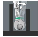
La clé mixte Joker 6003 avec sa fourche 12 pans et coudée à 7,5° double les possibilités d'ancrage lors de la rotation à 180° de la clé. Les écrous ou têtes de vis peuvent être « agrippés » tous les 15°. La Joker 6003 trouve pour ainsi dire d'elle-même le point d'ancrage suivant à chaque rotation.
