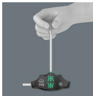
Die Klemmung der Innensechskant-Schraube auf der Werkzeugspitze wird durch eine federnde Kugel gewährleistet. Besonders hilfreich in schwer zugänglichen Arbeitsbereichen, wo man die zweite Hand nicht zum Festhalten der Schraube nutzen kann.
