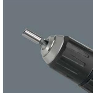
Universalhalter für die Aufnahme von Bits mit 1/4"-Außen-sechskantantrieb. Edelstahlhülse für besonderen Korrosionsschutz. Der Sprengring garantiert optimalen Sitz des Werkzeugs im Halter. Der starke Dauermagnet hält die Bits bombenfest. Passend für Schraubemaschinen mit Aufnahme nach DIN ISO 1173-F 6,3.
