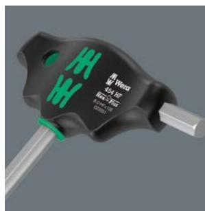
Der seitlich aus dem Griff austretende zusätzliche kurze Schenkel ermöglicht die Übertragung extrem hoher Drehmomente, indem der lange Schenkel als Hebel eingesetzt wird.
