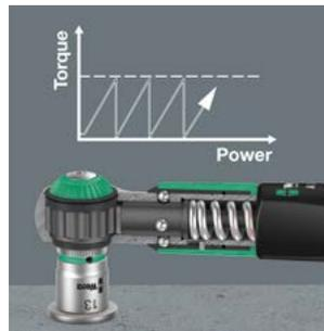
Der Drehmomentschlüssel Safe-Torque A 1 ist mit einer Übrerrutschmechanik ausgestattet. Nach Erreichen des eingestellten Drehmomentwertes kann das Werkzeug nicht überzogen werden, so dass das Aufbringen eines zu hohen Drehmomentes ausgeschlossen ist.
