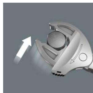
Grâce à ses mors parallèles à réglage automatique sans paliers, la clé Joker 7880 couvre toutes les dimensions du domaine d'application concerné. La clé s'ajuste d'elle-même, sans réglage, à la taille nécessaire au contact de l'écrou ou de la vis.
