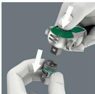
Le dispositif de blocage à bille permet un positionnement sûr des douilles et accessoires : serrage en toute sécurité. Une pression courte sur le bouton d'éjection et le changement d'outil est garanti dans toutes les positions définies.
