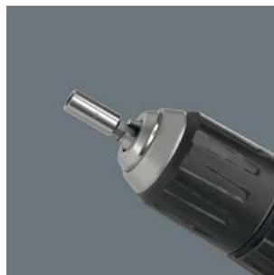
Il portainseri universale per inserti con codolo esagonale da 1/4". Manicotto in acciaio inox per una protezione ottimale contro la corrosione. L'anello di ritegno garantisce una ottimale tenuta dell'utensile nel portainseri. Il potente magnete permanente trattiene saldamente gli inserti. Adatto per trapani avvitatori con attacco secondo DIN ISO 1173-F 6.3.
