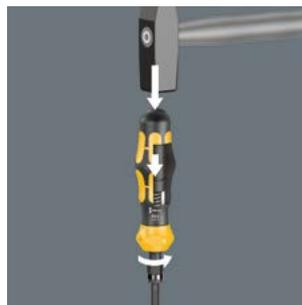
Quando la funzione giravite a battere è attivata, l'impulso del colpo di martello viene convertito in un movimento rotatorio con una coppia di allentamento fino a 25 Nm. La potenza viene trasmessa senza perdite tramite una lama passante.
