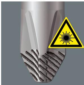
Con ayuda de rayos láser, se crea una estructura superficial de cantos afilados. Este tratamiento con láser proporciona una dureza de las ranuras de hasta 1000 HV 0,3. Lasertip de Wera se aferra en la cabeza del tornillo como si tuviera dientes, y de este modo evita la salida indeseada del destornillador de
