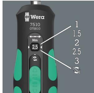
Cinco pares de apriete elegibles (7510: 1,0; 1,5; 2,0; 2,5; 3,0 Nm; 7515: 2,0; 3,0; 4,0; 5,0; 6,0 Nm) y una posición fija (Torque Lock) para unos pares de desapriete y apriete ilimitados.
