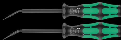
**Aplicación:** Desbloqueo de muelles de contacto en bornes electrotécnicos de línea; para bornes de muelles con un diámetro de cable de hasta 1,5 mm<sup>2</sup> o entre 2,5 y 4,0 mm<sup>2</sup>
