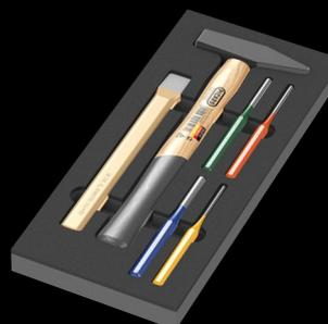
Juego de herramientas de 6 piezas (1 martillo de cerrajero PICARD® (500 gr), 4 punzones de chaveta exclusive de RENNSTEIG, 1 cincel plano de RENNSTEIG), en un depósito bicolor de espuma para el carro de herramientas "Tool Rebel" para el taller. Anchura x altura x profundidad: sin herramientas 172 x 30 x 392 mm, con herramientas 172 x 35 x 392 mm.
