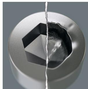
Los tornillos de hexagonal interior son problemáticos ya que las superficies de apoyo por medio de los cuales se transmite la fuerza de la herramienta al tornillo, son sumamente estrechas. Como consecuencia puede ser que se estropee la cabeza del tornillo. Las herramientas tipo Hex-Plus disponen
