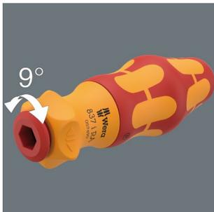
Встроенная трещотка с тонким механизмом зацепления (40 зубцов / угол возврата 9°) упрощает и ускоряет заворачивание упрощает и ускоряет заворачивание без нудных повторных накладки-ваний.
