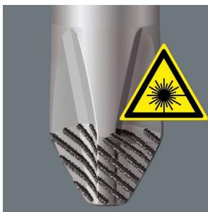
Узко сфокусированный луч лазера создает структуру поверхности с острыми кромками. Твердость профиля после обработки лазером составляет до 1000 HV. Наконечник Wera Lasertip крепко „цепляется“ за шлиц винта и предотвращает выскальзывание из него.
