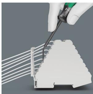
Клеммная колодка механически фиксирует концы проводников. Необходимая для этого сила в затяжной лапке обеспечивается пружиной. Чтобы ввести концы проводников, пружину следует отжать инструментом. Для работы с пружинными зажимами даже в ограниченном пространстве распределительных коробок служат специальные инструменты марки Wera. Изогнутый конец инструмента обеспечивает доступ к пружинному зажиму, что не получится сделать отверткой с прямым рабочим концом.
