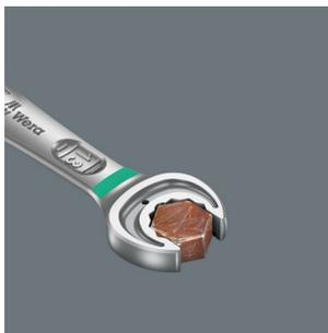
Умная геометрия двойного шестигранника Joker обеспечивает геометрическое замыкание с болтом или гайкой. А сменная, закаленная металлическая пластина в зеве Joker вцепляется очень прочными зубцами в болт. Все это предупреждает неприятное соскальзывание даже при больших моментах затяжки.
