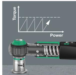
Динамометрический ключ Safe-Torque имеет проскальзывающий механизм срабатывания. При достижении выставленного момента затяжки ключ не перетягивает, что исключает приложение чрезмерного момента затяжки.
