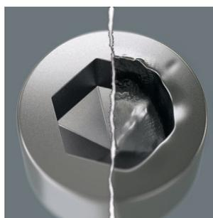
Проблема винтов с внутренним шестигранником Hex-Plus заключается в том, что этот профиль быстро скругляется. Причина этого связана с воздействием острых граней инструмента на внутреннюю поверхность головки винта. Процесс постепенного износа в итоге приводит к скруглению профиля.
