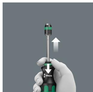
Простым нажатием на стопорную гильзу можно быстро выдвинуть рабочий стержень. Теперь ручку-держатель можно использовать как полноценную отвертку.
