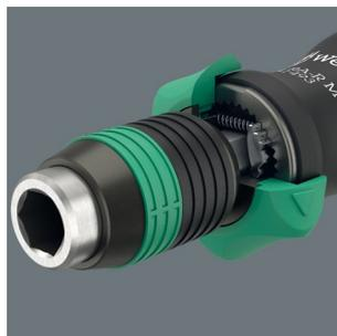
Встроенная трещотка с тонким механизмом зацепления служит для быстрой и надёжной работы. Механизм трещотки полностью помещается в ручке. Малый размер ручки позволяет заворачивать даже в очень ограниченном пространстве.
