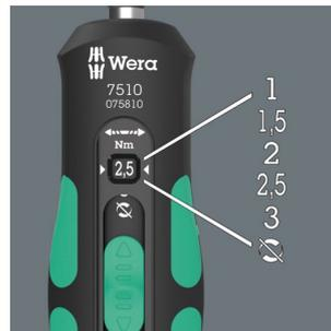
Пять значений момента затяжки по выбору (7510: 1,0; 1,5; 2,0; 2,5; 3,0 Нм; 7515: 2,0; 3,0; 4,0; 5,0; 6,0 Нм) плюс одно фиксированное положение (Torque Lock) для приложения неограниченного момента силы при срывании/затяжке крепежа.
